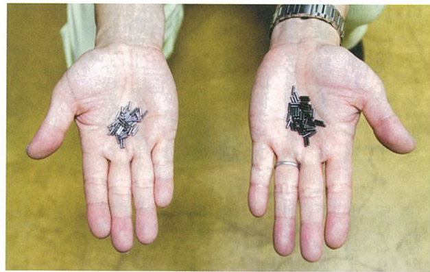
直径0.5~4mmの針状ころ。右は外径が研削される前の通称「黒皮」と呼ばれるもので、左が研削済み。東振テクニカル社製のマシンによりサブミクロン単位で加工される
